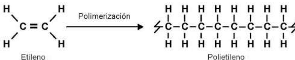
La figura muestra que el ETILENO (monómero) se repite miles de veces, utilizando una reacción llamada **Polimerización**; y da como producto el **POLIETILENO**.
